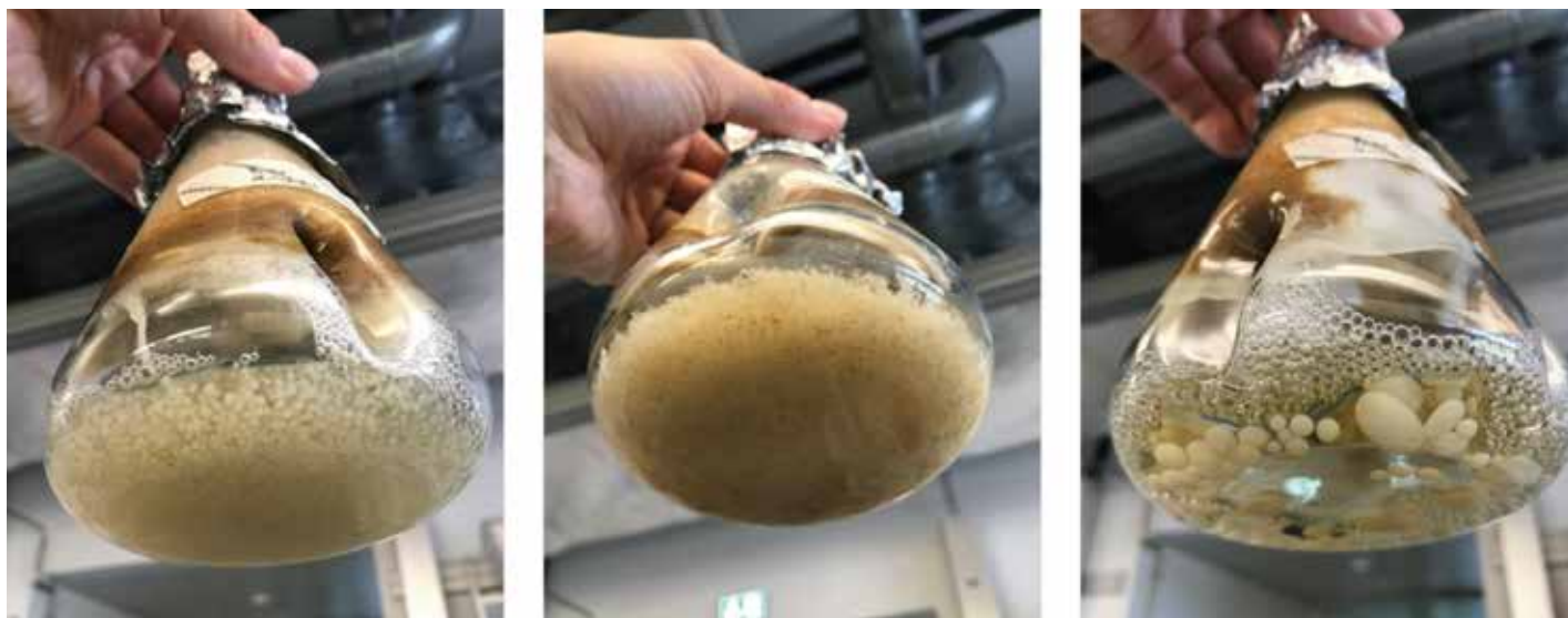
Figur 2. Fermentering under forskellige betingelser kan bruges til at styre svampens morfologi. På billedet ses den samme svamp, Rhizopus oryzae , vokse som små homogene bolde (venstre), som heterogen filamentøs biomasse (midt) og som større heterogene klumper (højre). Morfologien påvirker proteinproduktion og er én af mange faktorer, der skal optimeres i en succesfuld præcisionsfermenteringsproces.
