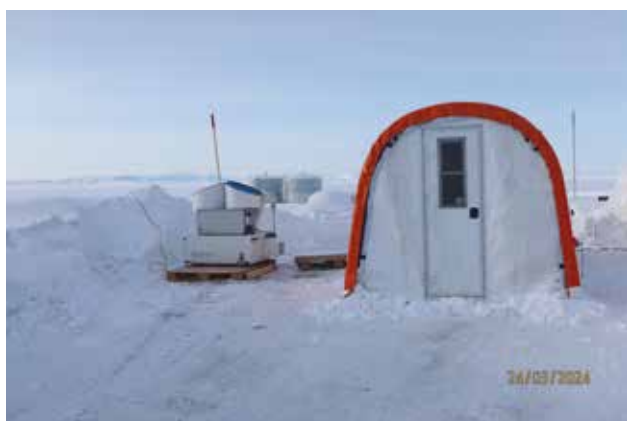
Figur 2. Til venstre ses skyradar og telt med en polariseret sky LIDAR, der tilsammen måler skyhøjde, -densitet og udstrækning samt fordelingen af vand- og ispartikler i skyen. Til højre (foto: Lionel Favre, EPFL i Schweiz) ses helikite udstyret med meteorologimåleudstyr samt instrumenter til at måle aerosolparametre (absorption og spredning af lys samt antallet af aerosoler).
