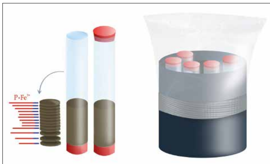
Figur 1. Visualisering af opskæring af sedimentkerner til fraktionering samt opsætning af anoxiske fluxforsøg.
