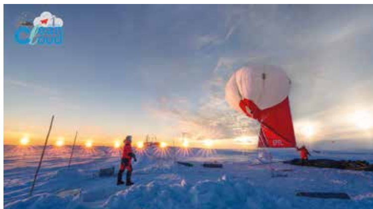
Figur 2. Til venstre ses skyradar og telt med en polariseret sky LIDAR, der tilsammen måler skyhøjde, -densitet og udstrækning samt fordelingen af vand- og ispartikler i skyen. Til højre (foto: Lionel Favre, EPFL i Schweiz) ses helikite udstyret med meteorologimåleudstyr samt instrumenter til at måle aerosolparametre (absorption og spredning af lys samt antallet af aerosoler).
