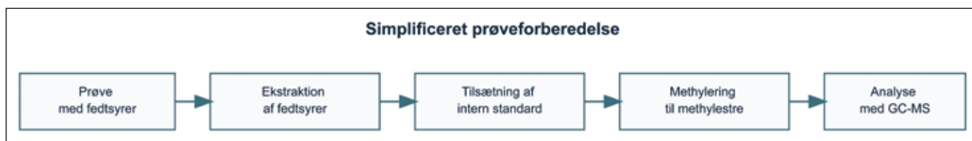
Figur 1. Simplificeret flowdiagram for prøveforberedelse ved analyse af fedtsyresammensætning med GC-MS.
