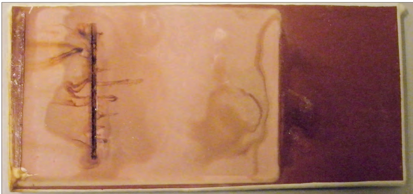
Figur 1. Epoxymaling som har været eksponeret for ultraviolet (UV) lys og fugt. Den røde del af malingen i højre side har ikke været eksponeret, den lyse del har været eksponeret for UV-lys. Det dannede lyse lag kaldes "kridtning" og skyldes pigmentstøv ( \text{TiO}_2 ), som sidder tilbage efter at binderen (og måske andre komponenter) er blevet nedbrudt og eroderet væk. Til venstre i billedet ses en kunstig revne som skyldes, at malingspanelet har været brugt i en korrosionstest, hvor UV-lyseksponering blot er en del af forløbet.
