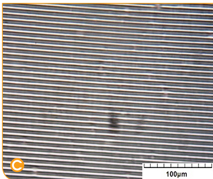
Figur 4. Billeder af struktureringen i både makro- og mikroskala. Billede A viser makrostruktureringen, mens billede B viser fordybningerne i filmen ved makrostruktureringen. Billede C illustrerer mikrostrukturen i overfladen af filmen, og billede D illustrerer filmens tværsnit, og dimensionerne af mikrostrukturen.
