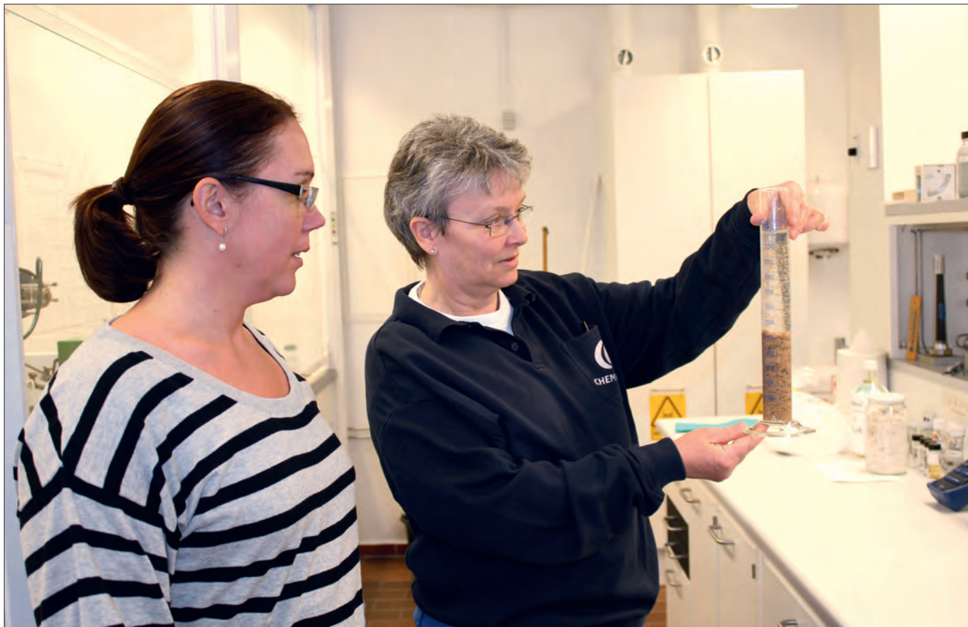
Spildevandsslammets egenskaber vurderes blandt andet ved en flokkuleringstest.
