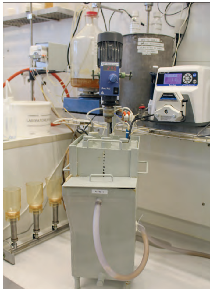
Chemostaten er koblet op med tilfødningspumpe, omrøring og udtag til måling af temperatur og pH.
