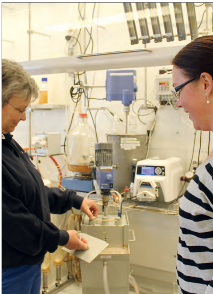
Senior laboratorietekniker, Inger Skov, og udviklingsingeniør, Heidi Gade Andersen, overvåger chemostaten, der er opstillet i et stinkskab i et af udviklingslaboratorierne.
