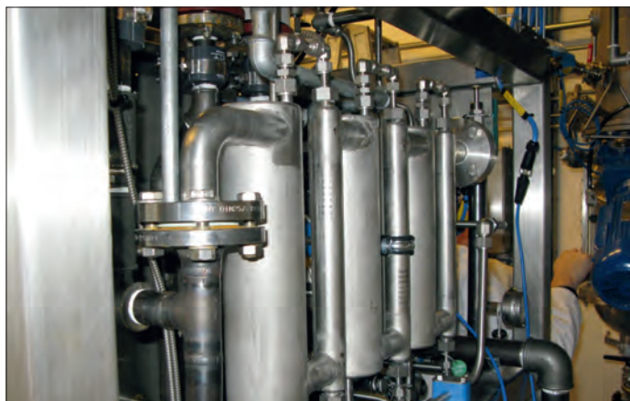
Figur 4. Sidestrømsreaktordelen af den kontinuerte reaktor. Sidestrømsreaktoren har multipel tilføring af AllylMgCl for at undgå overtitrering, og opblandingen intensiveres efter hvert blandedpunkt med statiske blandere.
