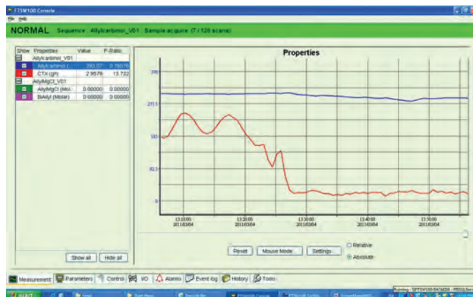
Figur 5. Screen dump af valideringen af sidestrømsreaktorens effekt på omsætningen af CTX. Målingen foretages med et NIR-instrument med tilhørende flowcelle efter sidestrømsreaktoren. Den blå kurve er alkoxidion-koncentration, og den røde er CTX-koncentrationen. Det ses tydeligt, at CTX ikke er fuldt omsat i første del af forløbet, men omsættes ved tilledning af AllylMgCl til sidestrømsreaktoren.
