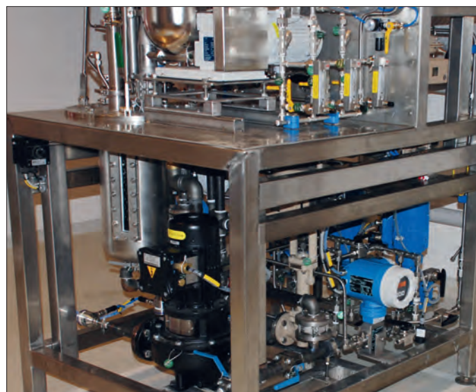
Figur 6. Nærbillede af den nedre del af reaktor-setuppet, hvor størrelsen af filterreaktordelen til venstre på billedet tydeligt kan ses ift. de blå doseringspumper og den sorte centrifugalpumpe i fronten til kølekredsen.
