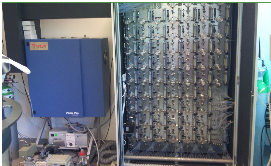
Prima PRO er hos DTU Systembiologi tilsluttet til 50 fermentere.
