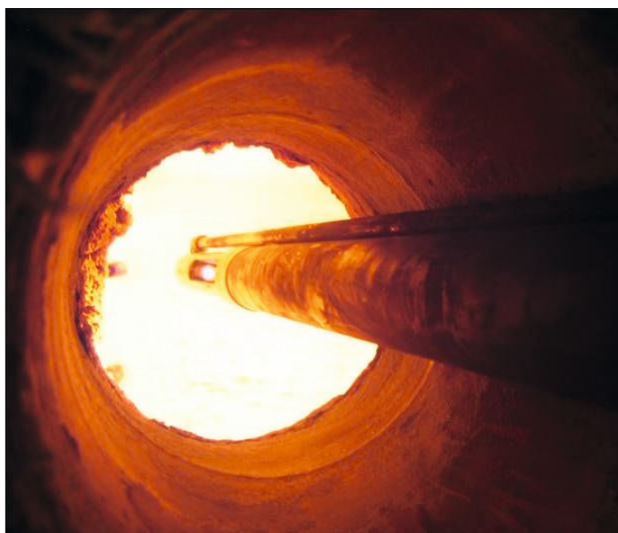
Figur 1. Vandkølet UV-måleprobe indsat i kraftværksflamme via måleport i kedel (billede t.v.). Måling af NO kort efter udstødningsventil på MAN Diesels testmotor med høj tidslig opløsning med ind- og udkobling af UV-lys med kvartslysledere (blå i billede).
