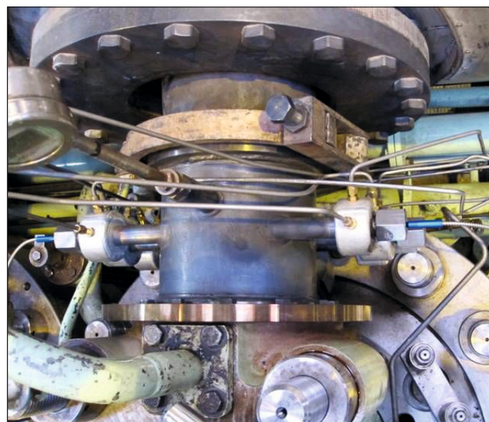
Figur 1. Vandkølet UV-måleprobe indsat i kraftværksflamme via måleport i kedel (billede t.v.). Måling af NO kort efter udstødningsventil på MAN Diesels testmotor med høj tidslig opløsning med ind- og udkobling af UV-lys med kvartslysledere (blå i billede).
