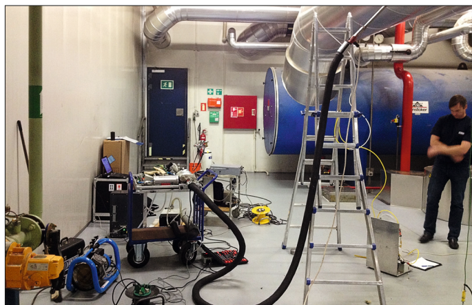
Figur 1. Måling af ultrafine partikler på et gasmotorfyret kraftvarmeværk.
