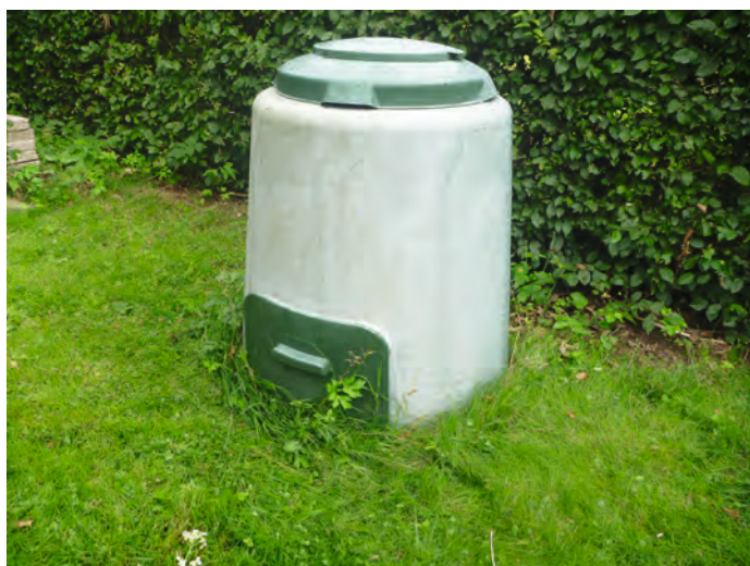
Figur 1. Kompostbeholder, som har været udsat for sollys og fugt igennem en årrække. Den (oprindelige) grønne farve bliver gradvist mere mat og hvidlig, fordi plastmaterialet (og eventuelt organiske pigmenter) nedbrydes og de hvide \text{TiO}_2 -pigmenter (som er tilsat for at give en høj dækkeevne) sidder tilbage på overfladen. Fænomenet kaldes kridtning. Foto fra forfatterens have.
