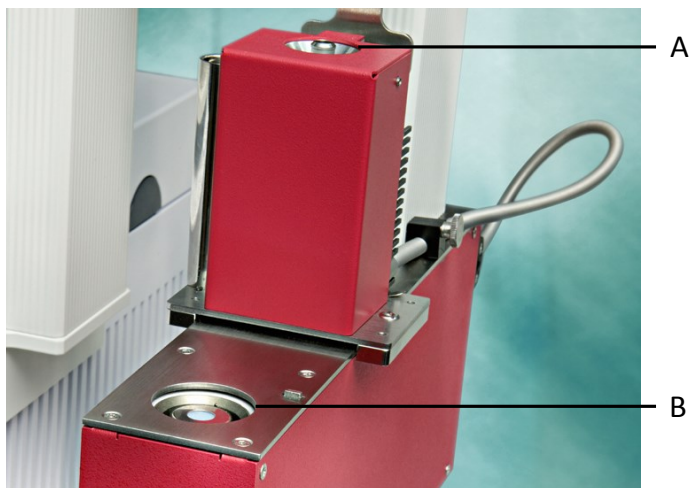
Figur 2. Gerstel DHS monteret på autosampleren. A: Holder til adsorptionsrør og B: Holder til vial med prøve. Holderen A er monteret på en slæde, ved analyse køres A over B, og dobbeltnålen forbinder de to enheder.
