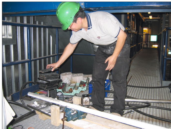
Figur 3. En belægningssonde efter eksponering, Avedøreværket, blok 2, november 2005.
