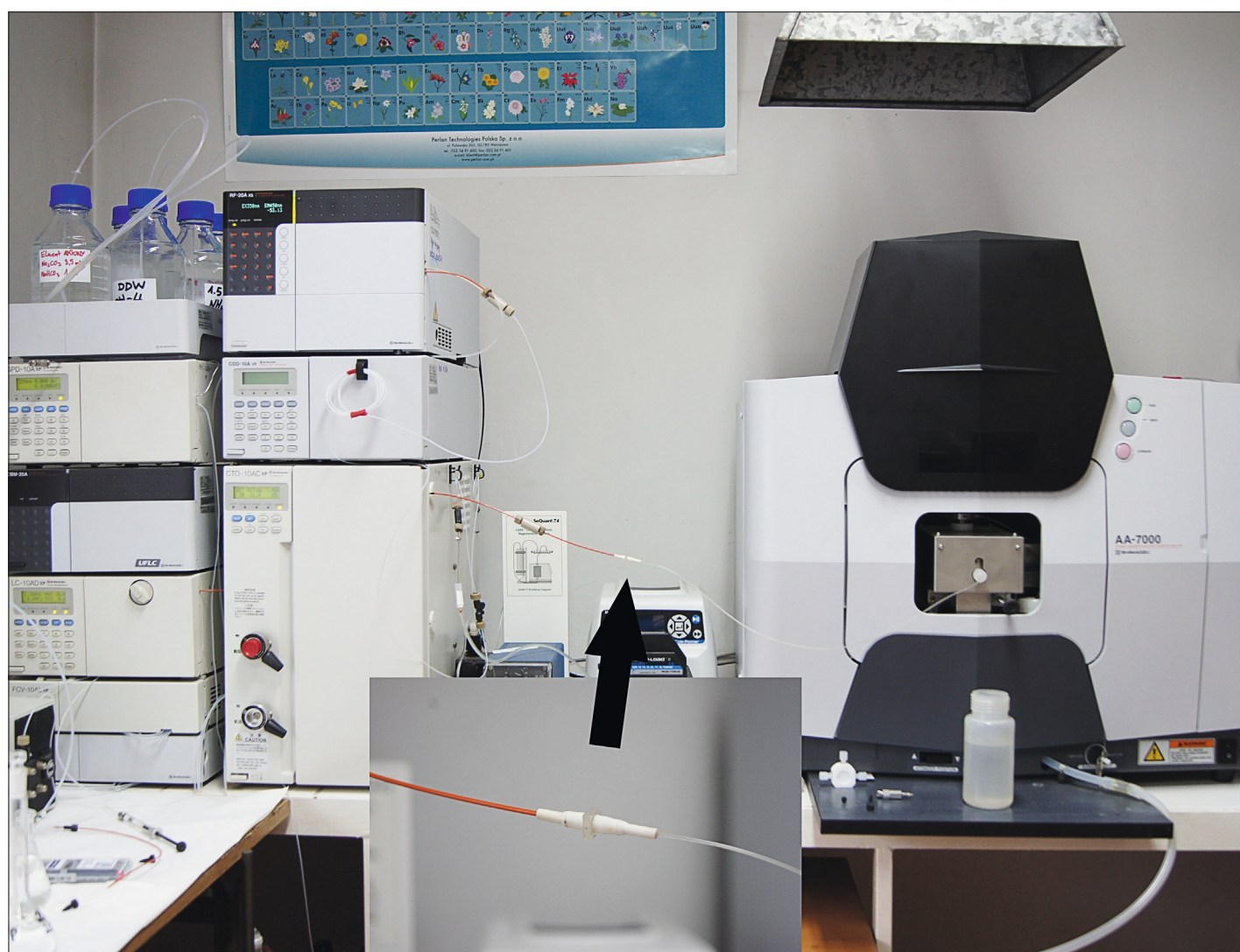
Figur 1. HPLC-FAAS-analysesystem anvendt i laboratoriet i Afdeling for analyse af vand og jord, Kemisk Fakultet, Adam Mickiewicz Universitetet i Poznan, Polen. I den røde kasse ses forstørrelse af forbindelsen mellem HPLC og FAAS. Efter prøven er analyseret på HPLC flyder den umiddelbart videre til FAAS til videre analyse.
