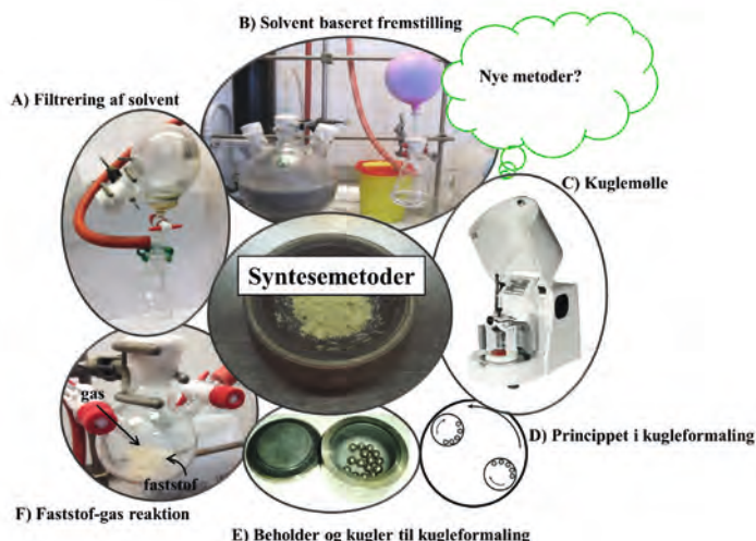
Figur 2. Illustration af en række forskellige syntesemetoder. Ved at kombinere flere metoder som eksempelvis solvent-baseret kemi og mekanokemi (kuglemølle) åbnes nye muligheder for at skræddersy sammensætningen af nye kemiske forbindelser, der ikke tidligere er beskrevet.
