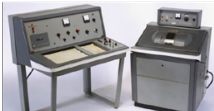
Figur 2. Et Varian A-60 NMR-spektrometer som det, der blev installeret ved Kemisk Laboratorium V, Københavns Universitet i begyndelsen af 1960'erne.
