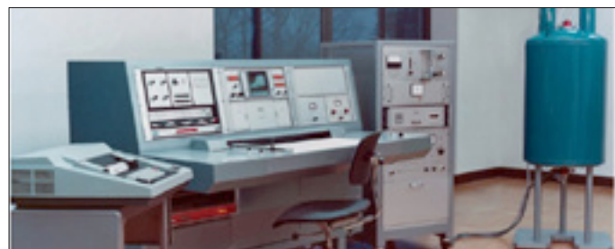
Figur 5. Et Bruker HX-270 NMR-spektrometer som det, der blev installeret ved Kemisk Laboratorium V, i midten af 1970'erne som det første NMR-spektrometer i Danmark med superledende magnet.
