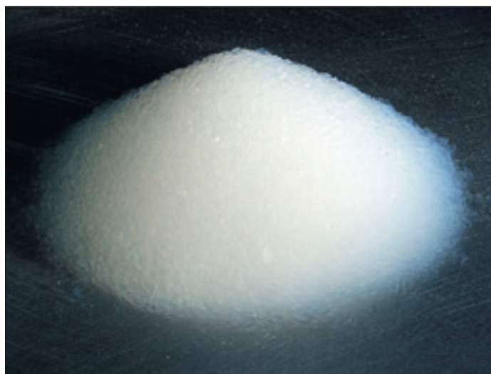
Figur 1. Foto af aerogelpartikler, som kan anvendes i isolerende maling. Partiklerne på billedet er i størrelsesintervallet 100-1.200 \mu\text{m} (0.1-1.2 mm). Partikeldensiteten er 120-150 \text{kg}/\text{m}^3 , og varmeledningsevnen hævdes at være kun 12 \text{mW}/(\text{m}\cdot\text{K}) ved 25°C [1], hvilket er under det halve af luft. Prisen er aktuelt, ifølge [10], $55 for 1 liter og $792 for 20 liter af pulveret.
