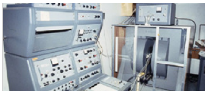
Figur 4. Et Varian HA-100 NMR-spektrometer som det, der blev installeret ved Kemisk Laboratorium V, Københavns Universitet omkring 1967.
