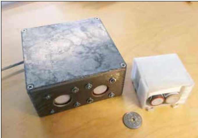
Figur 4. Første sensor-prototype i metalboksen og version 2.0 i den lille hvide plastboks. Mønten er en dansk to-krone.
