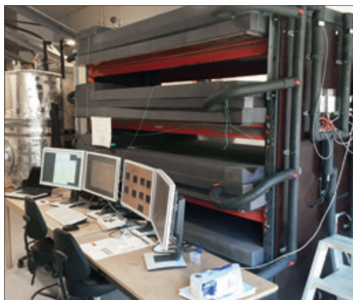
Forsøgsopstilling af fire varmelagerenheder, vandlager og monitorering.
