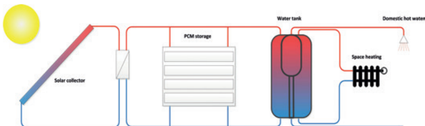
Principdiagram over solvarmeanlæg med sæsonvarmelager.
