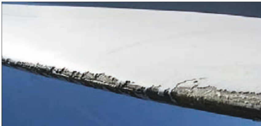
Figur 1. Vindmøllevinge med skade på vingens forkant efter regnerosion. Gengivet fra [1].
