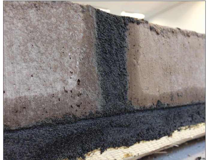
Figur 4. Fremstilling af murstensvæg med mørtel, der har et indhold på 93% arvedsonit-fraktion fra malmen fra Sydgrønland.
