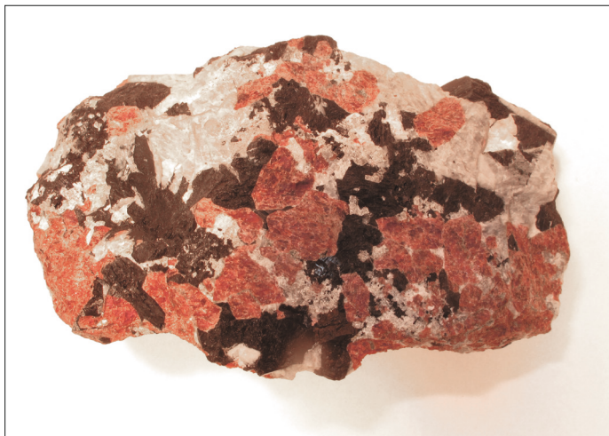
Figur 2. Sten fra forekomsten i Kringlerne. Mineraler eudialyt, som primært er sted for sjældne jordarter i forekomsten, er rødt. Den hvide del stammer fra feldspat, som bl.a. anvendes til fremstilling af porcelæn. Den sorte del indeholder jernholdigt arfvedsonit. Arfvedsonitten havde oprindeligt ikke fundet nogen anvendelse og ville planmæssigt blive deponeret.
