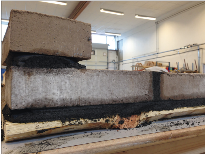
Figur 4. Fremstilling af murstensvæg med mørtel, der har et indhold på 93% arvedsonit-fraktion fra malmen fra Sydgrønland.
