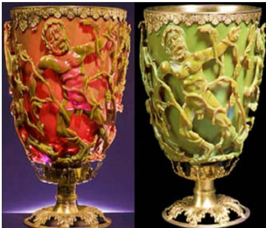
Figur 1. Lycurgusbægeret, Rom 4. århundrede efter Kr. British Museum. Tv.: lysabsorption, th.: lysspredning. Farvespillet er forårsaget af 50 nm AuNP'er (strengt taget Au/AgNP'er) i glasset. Rødt viser absorption, grønt refleksion.
