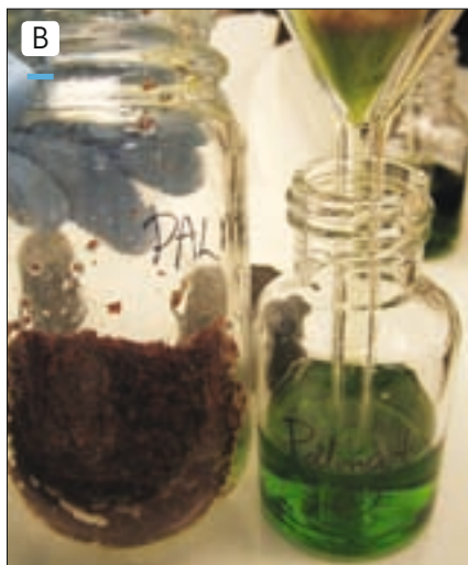
Billede a og b. Ekstraktion af Palmaria palmata (rødalgen søl) for at analysere lipidindholdet. Ved tilsætning af solventer og efter centrifugering lagdeles komponenterne (a). Da klorofyl a (grønkornene) er lipidopløselige kommer disse med ud i ekstraktet i modsætning til de pigmenter, der giver den flotte røde farve, som stadig er i biomassen (b). Fotograf Susan L. Holdt.
