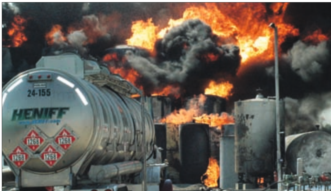
Statisk elektricitet udløser en eksplosion inden i en tank med brandfarlig væske i et tanklager i Kansas. Link: www.csb.gov . (CSB = U.S. Chemicals safety board) (Her kan findes en video og en rapport om uheldet: Rapport: Barton Solvents, Static spark ignites explosion inside flammable liquid storage tank)
