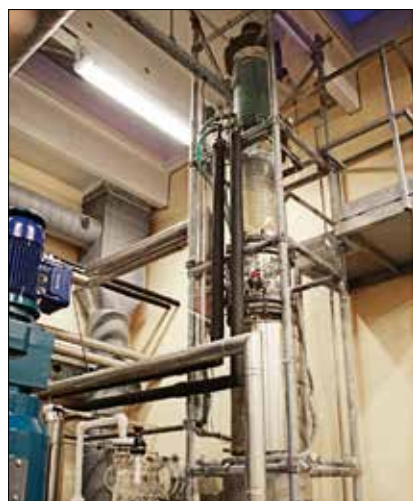
Figur 3. Glaskolonne med to svalere (vand og glycol) til køling af afkastluft og reflux af toluen og reaktanter. Reaktionsbeholderen under glaskolonnen kan ikke ses på dette foto.
