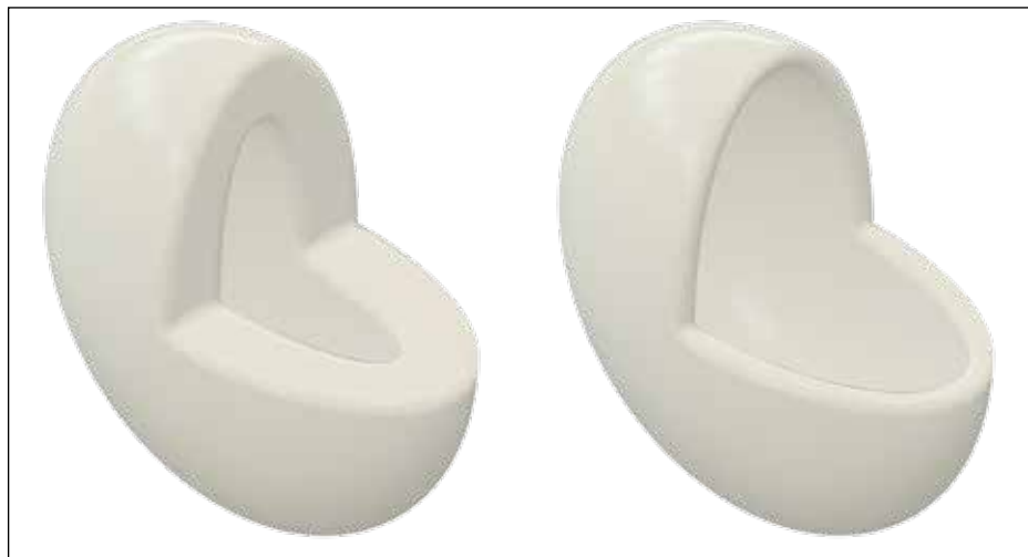
Figur 1. Skematisk repræsentation af en 3D-printet lægemiddelform med tyk væg (venstre) og tynd væg (højre).
