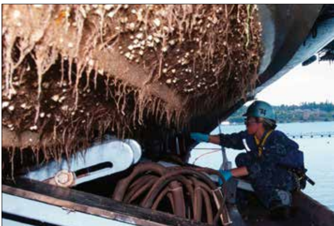
Figur 1. Inspektion af begroning på en skibsside [4].
