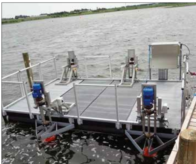
Figur 3. Forskningsstation (tømmerflåde) i Roskilde Fjord med fire neddyppede malingscylindere (to af dem kan skimtes med deres røde farve under vandet). Hver cylinder har sin egen motor. Efter [3].
