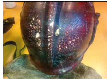
Den norske rapport bemærker tørt, at hvis der skal siges noget positivt om denne hændelse, så må det være, at brandvæsenets mundering fungerede rigtig godt - her en brandskadede hjelm.
