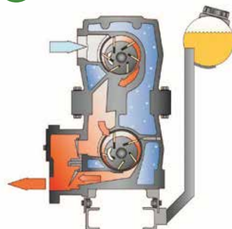
Driftsprincippet for Huckepack oliesmurt lamelvakuumpumpe, med enkelt olie gennemløb.
