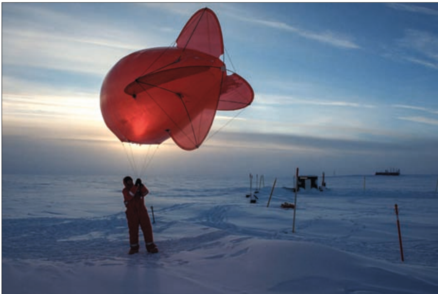
Tropos i Leipzig deltog med en tøjret ballon, hvorfra der blev målt vertikale profiler af meteorologi op til 1.000 m. Foto: Esther Horvarth.
