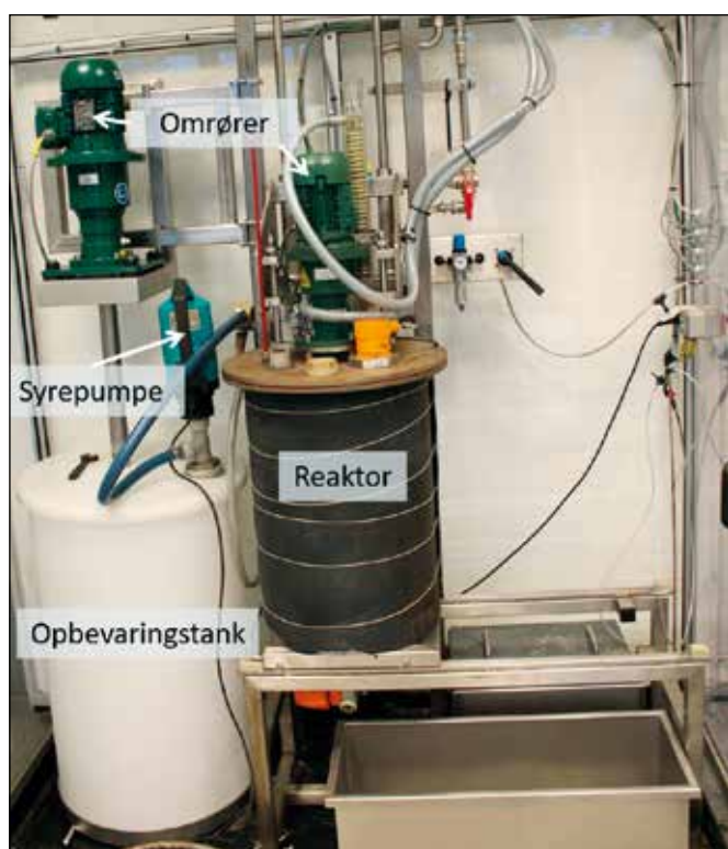
Figur 2. En 75 liters pilotskala replika af en omrørt udludningsreaktor. Reaktorlåget kan løftes og reaktoren kan køres til siden for at få adgang til malingsprøverne, der er placeret i bunden af reaktoren.
