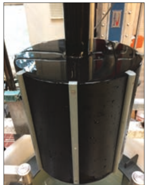
Figur 1. Til venstre: pilot-skala rotorudstyr til måling af friktionsmodstand. I midten: cylindrisk rotor udført i polyvinylklorid (uden påført bundmaling). Til højre: fleksibel rotor (af glat polyoxymethylen) med op til seks kunstige svejsesøm på den ydre overflade.
