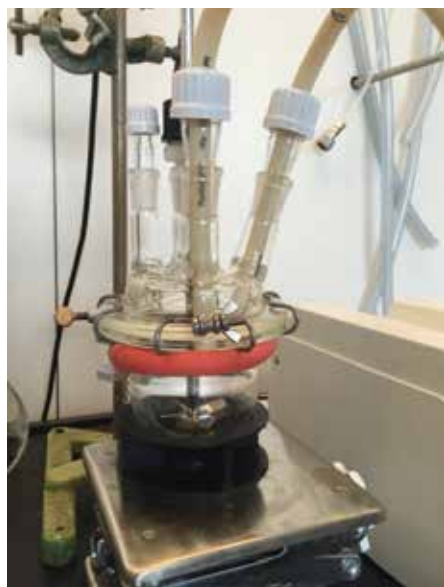
Figur 4. Venstre: Billede af den velomrørte reaktoropstilling med indfødnings af \text{H}_2\text{SO}_4 og smøreolie. Højre: Billede af reaktoren under et forsøg.
