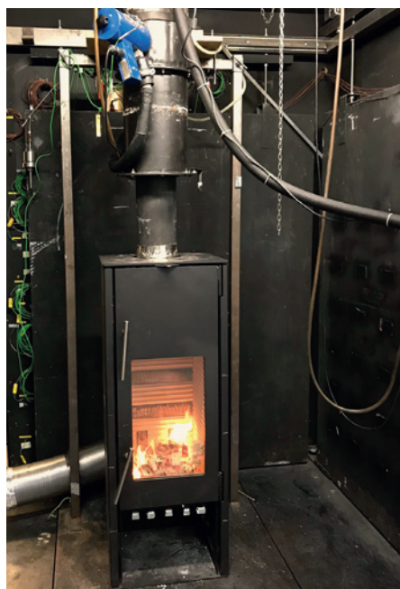
Figur 2. Måleopstilling som til dagligt bruges til test og certificering af nye brændeovne.
