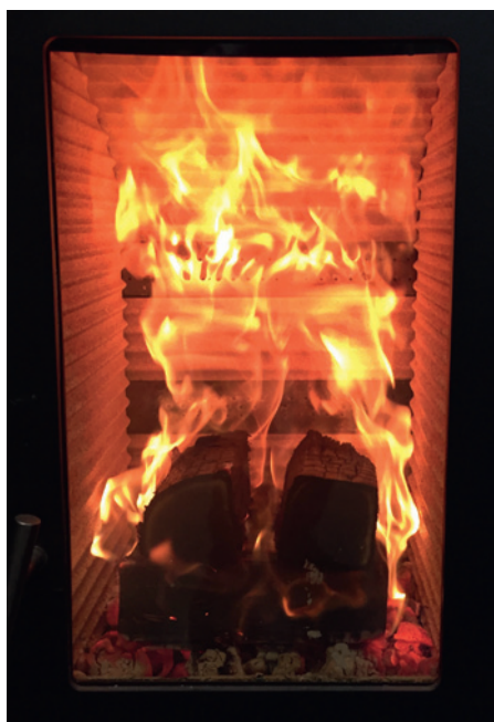
Figur 1. Brændeovn kort efter påfyldning med dobbelt mængde træ (3.-4. påfyldning).
