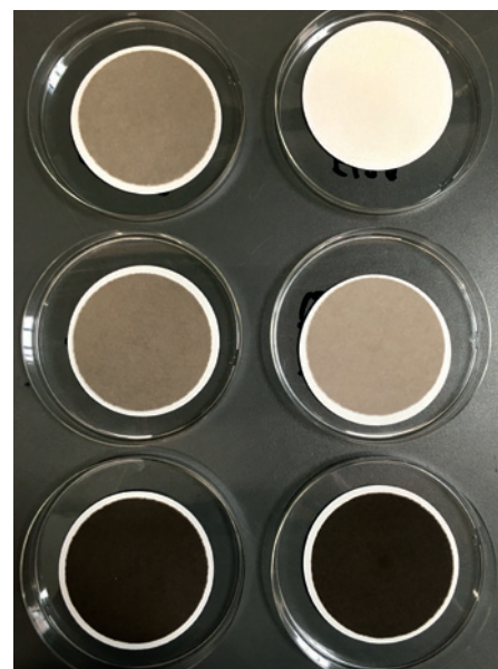
Figur 3. Filteroversigt efter forsøg vist i kronologisk rækkefølge: ø.tv. optætning, ø.th. blank filter (reference), m.tv. 1. påfyldning, m.th. 2. påfyldning, n.tv. 3. påfyldning og n.th. 4. påfyldning.
