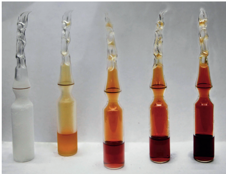
99,5 procent ren rødbrun \text{NO}_2 -gas i ligevægt med sin farveløse dimer \text{N}_2\text{O}_4 ved forskellige temperaturer. Dimerens smeltepunkt er -11,2^\circ\text{C} . \text{NO}_2 -gassens farve beskrives ofte som ræverød. Temperatur fra venstre mod højre er -196^\circ\text{C} , 0^\circ\text{C} , 23^\circ\text{C} , 35^\circ\text{C} og 50^\circ\text{C} .
