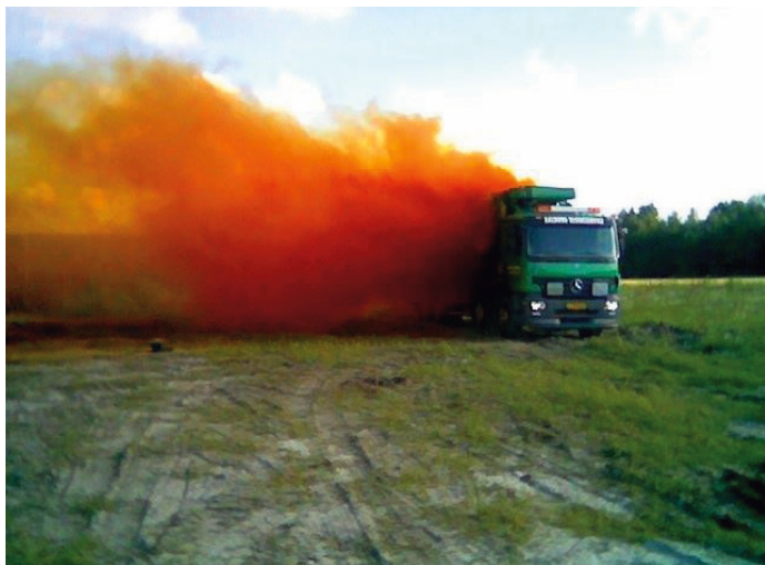
Den første slamsuger var ikke egnet til koncentreret salpetersyre. Næsten omgående blev der dannet store mængder af nitrøse gasser.
