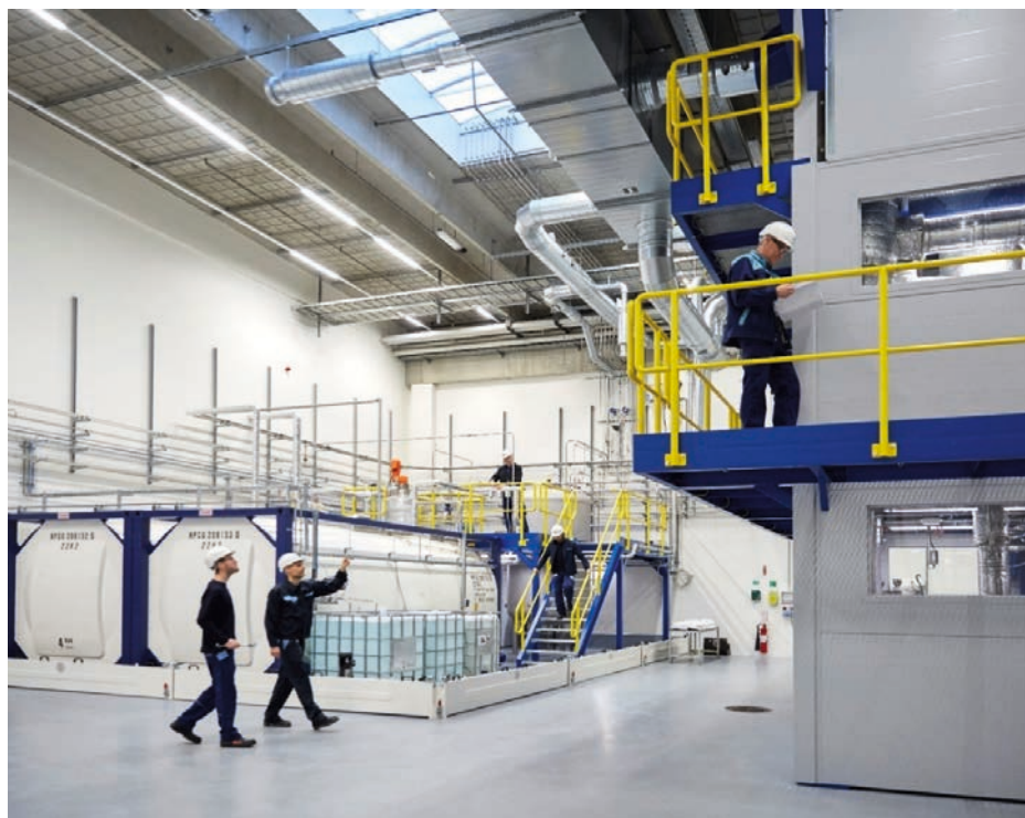
Figur 5. Sukkerkrakning demonstrationsanlæg i Lyngby med 50 kg/time kapacitet.
