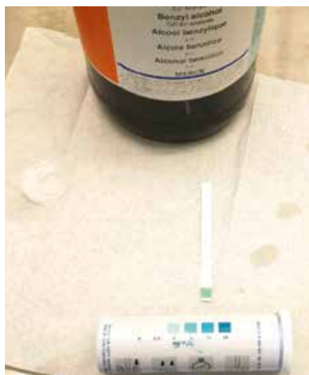
Figur 1. Måling af benzylalkohol (flaske 2) med peroxid-teststrips. Indholdet aflæses på den medfølgende referenceskala. Strippen har antaget en grønlig tone, der ikke fuldstændig matcher skalaen. (Ved måling med titanoxysulfat-metoden blev peroxidindholdet i samme flaske bestemt til 5.000 ppm).
