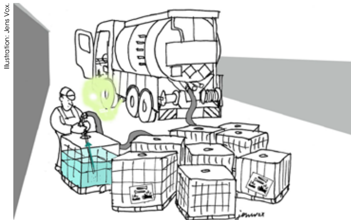
Figur 2. Chaufføren blev forgiftet af tre omgange. CO kan ikke lugtes og begyndende forgiftning er tit uden symptomer. 1) Slamsugerens vakuumpumpe afleverede afkastet i terræn og ikke i højden. 2) Chaufføren opdagede, at tanken var blevet varm, og aftalte med sin formand at pumpe affaldet tilbage. 3) Fortrængningsgasser fra palletankene havde meget højt CO-indhold. 4) Chaufføren ville skylle de sidste rester ud. Dampene fra det åbne domedæksel slog ham ud.
