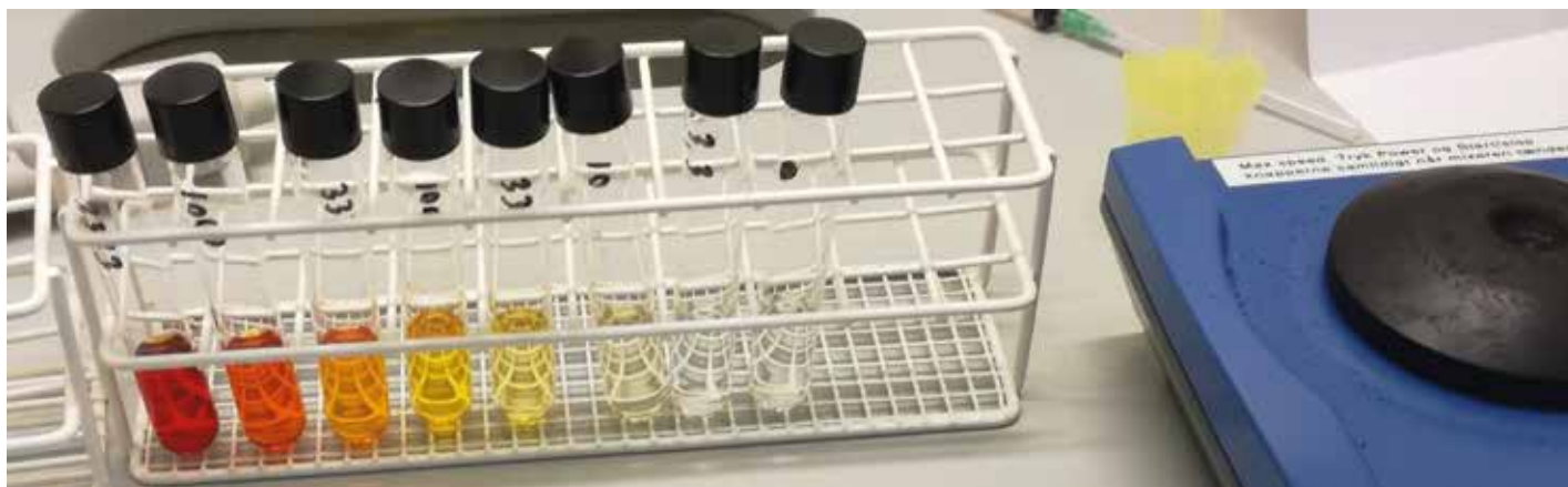
Figur 2. Standardrække med titanoxysulfat-reagens ud fra H_2O_2 (fra 3333 til 3,3 ppm - laveste standard kan dog næppe skelnes fra 0).
