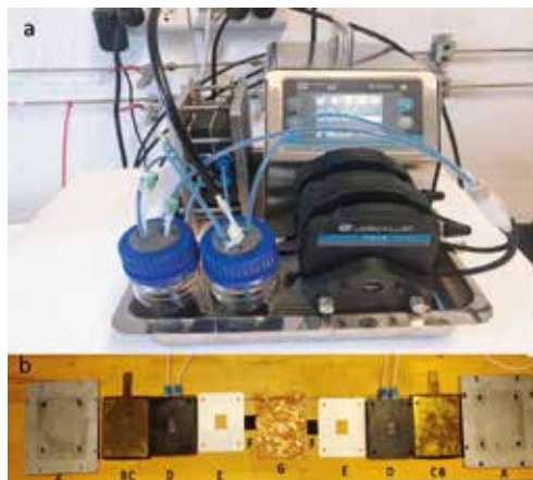
a) Redox flow batteri-setup hos Blue World Technologies, b) Cellesamlingsekvens, c) Størmforsyning.
