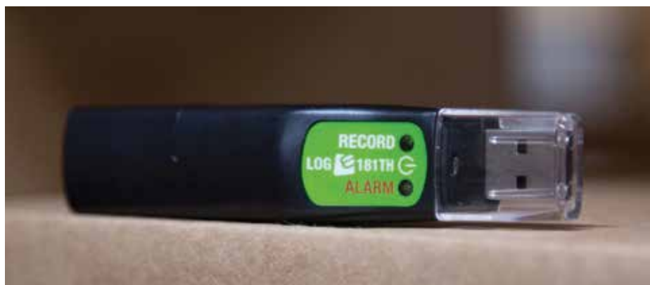
Elma DT-181 TH kan lægges på skrivebordet og logge fugt- og temperatur over timer, dage eller måneder.
