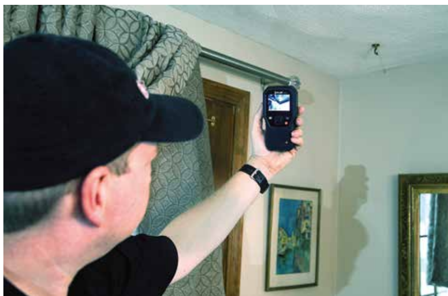
Flir MR160 fugtmåler kombinerer IR, RH og temperatur til afdækning af risikooverflader.
