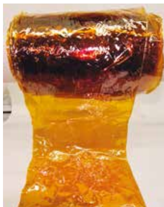
PBI membranproduktion hos Blue World Technologies.
