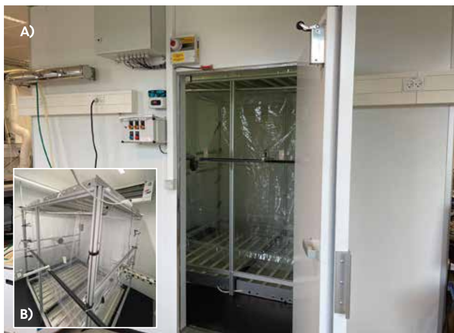
Figur 1. Klimakammeret (Aura), som bruges til simuleringer af reaktioner og processer i den nederste del af atmosfæren. (A) Klimakammeret set ude fra laboratoriet. (B) Klimakammeret set inde fra kølerummet. Teflonposen hænger på metalstativet, som har lamper foroven og -neden til at simulere sollys.
