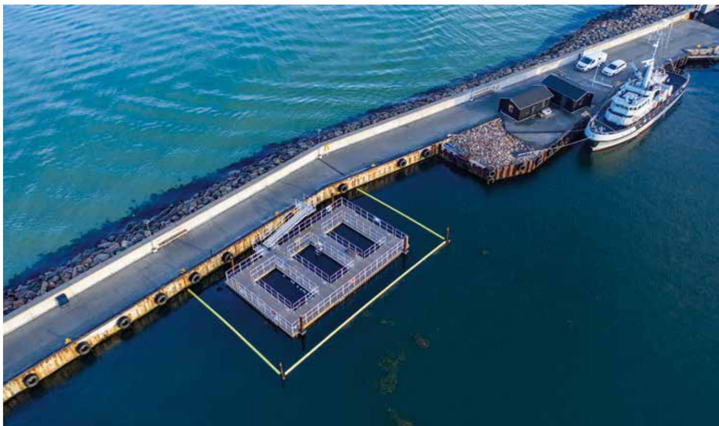
Figur 1. CoaST testflåde til feltafprøvning af antifoulingmaling (set fra luften). Testflåden er beliggende i Hundested Havn.
