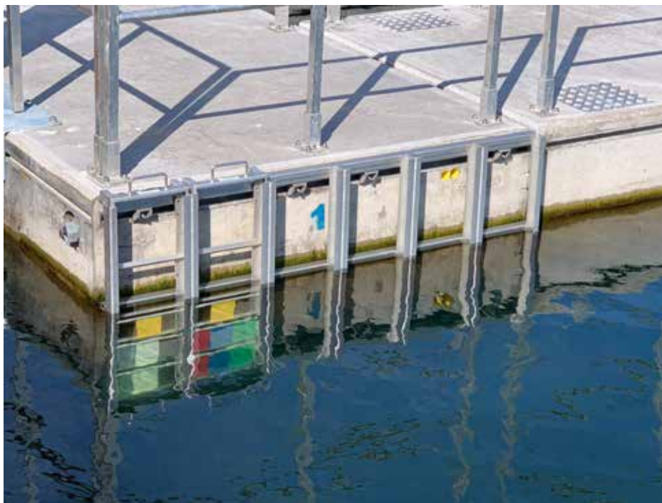
Figur 2. Testpanelerne er fastspændte til rustfri stålrammer (cirka 0,3 x 1,2 meter), der via en række styr på selve testflåden fastholdes til denne i neddyppet tilstand. Ved inspektion kan rammerne let trækkes ud af vandet og sættes på flåden, se figur 3.
