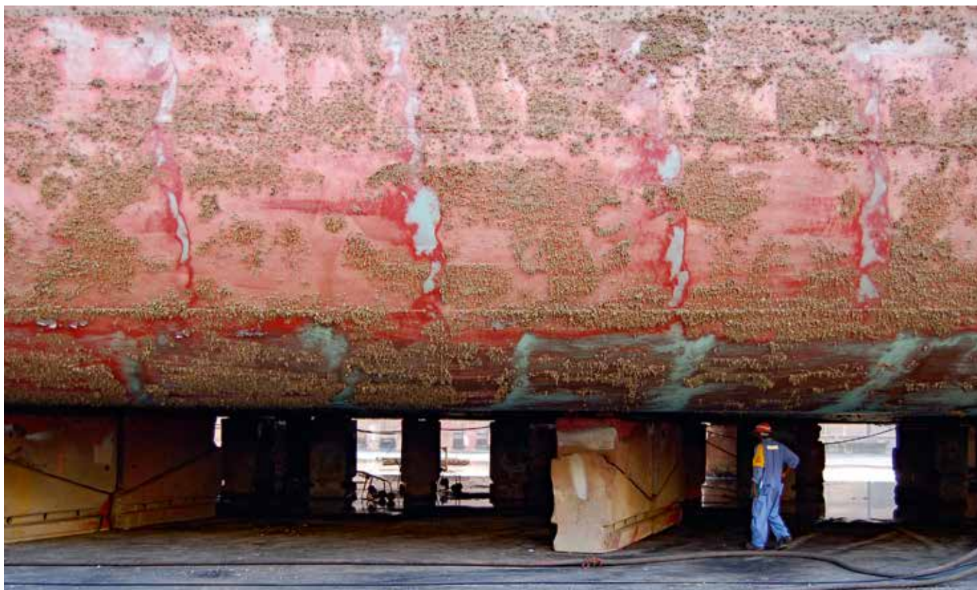
Figur 5. Skibsside med kritisk begroning af marine organismer.
