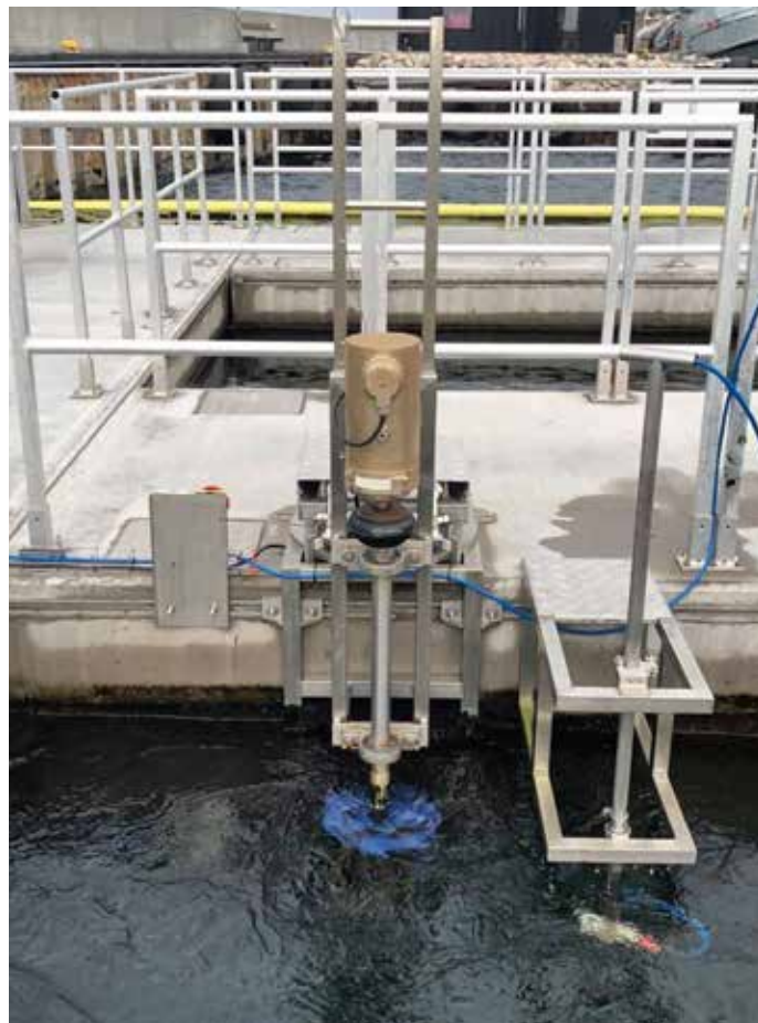
Figur 4. Skibssimulator, eller rotor, til dynamisk afprøvning af antifoulingmaling. Malingsprøverne er lagt på cylinderen, som roterer under vandoverfladen. Forinden i højre hjørne af billedet kan ses et undervandskamera, der følger den roterende cylinder live.
