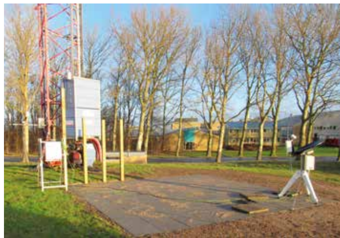
Den nye terrasse ved Risømasten for remote-sensing instrumenter. Det første ACTRIS-DK-instrument, en Micro Rain Radar, står i det højre hjørne.
