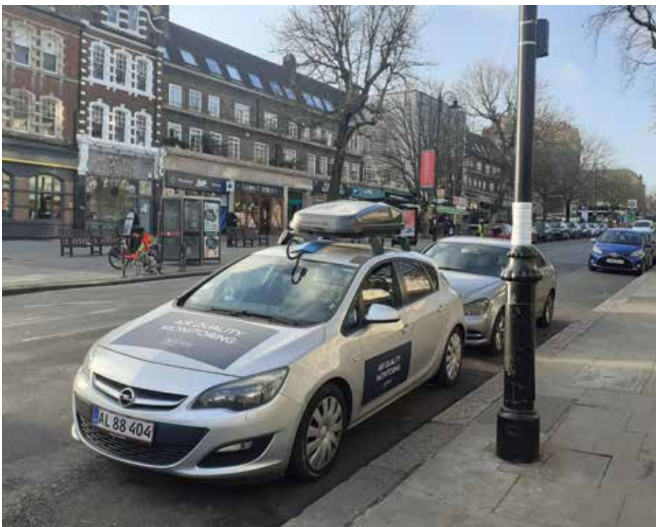
Figur 2. MAPS-bilen under målekampagnen. Øverst ses et nærbillede af bilen, hvor man kan se indtagningen på taget og tagboksen. Nederst er bilen parkeret foran en lygtepæl, hvorpå der er monteret en low-cost sensor.
