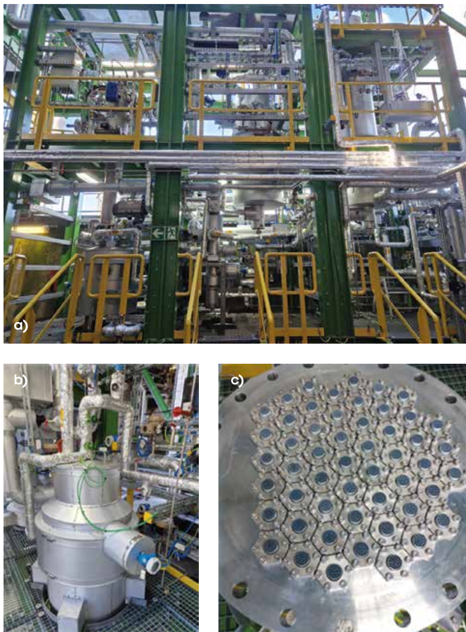
Figur 3. a) Modulært SLP demonstrationsanlæg til hydroformylering i tilknytning til valeraldehyd produktionsanlæg hos Evonik Oxeno, Marl, Tyskland. b) Den katalytiske membranreaktor. c) De 54 monolitter monteret i reaktoren set ovenfra.
