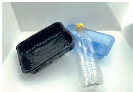
Figur 1. Eksempler på PET-produkter i husholdningsaffald er diverse bakker til kød og grønt samt drikkeflasker. Produkterne indeholder ofte enten PE eller PP i form af en film på indersiden af bakkerne eller som låg på flaskerne.
