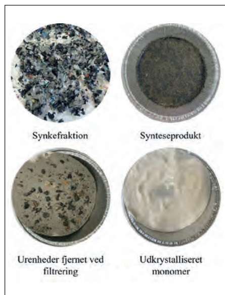
Figur 5. Billeder fra plastaffald til monomeren bis(2-hydroxyethyl) terephthalat (BHET), hvilket inkluderer den ubehandlede synkeaffaldsfraktion, synteseproduktet fra det hydrolyserede materiale, urenheder fjernet fra BHET synteseproduktet ved hjælp af filtrering og det rene udkrystalliserede BHET.
