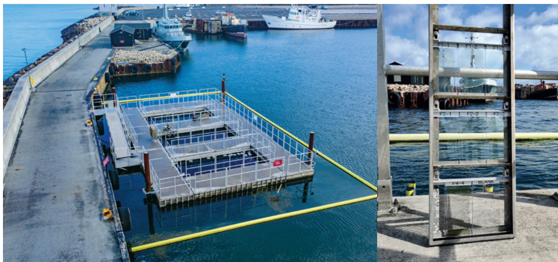
Figur 3. Malingteststation i Hundested Havn med plads til 4.500 neddyppede, statiske paneler og otte roterende cylindere (venstre foto). Til højre ses en ramme, inden neddykning, med transparente polykarbonatsubstrater bemalede med transparente solcellemalinger. Foto til højre er gengivet fra [4] med tilladelse fra Elsevier og fotografen er Narayanan Rajagopalan. Venstre foto er taget af tidligere ansat i CoaST, Torben Rasmussen.
