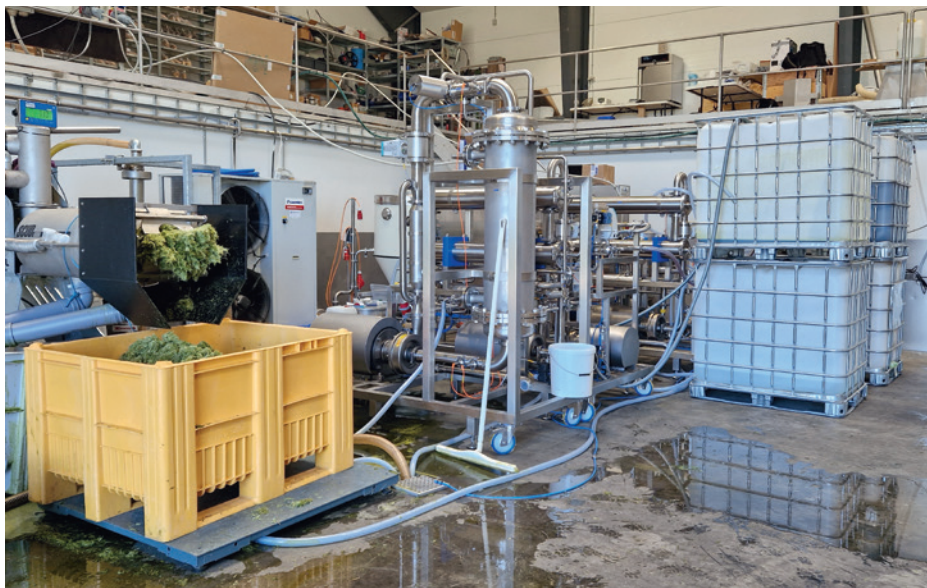
BiomassProtein's pilotanlæg til udvinding af proteiner ved hjælp af membranfiltrering.
