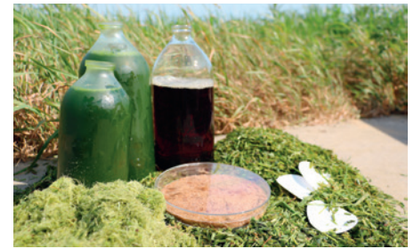
Pulp, græssaft, membranfiltreret grøn græssaft (efter 1. filtrering), og membranfiltreret saft (efter 2. filtrering). Derefter kan de opkoncentreres og tørres.
