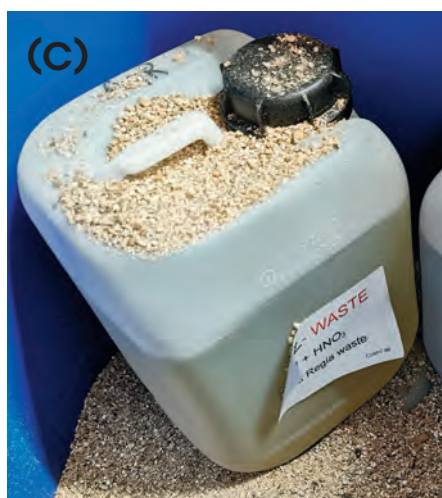
Figur 5. Vermiculit (A) findes i de fleste laboratorier, hvor der arbejdes med kemiske materialer. Her ses et kemikalieaffaldsdepot, hvor vermiculit leveres i store sække (B) og bruges som pakkemateriale: Beholdere med kemikalieaffald pakkes i blå spændelågsfade (C), hvor vermiculit udgør fyldmaterialet under og imellem dunkene. Sækkene med vermiculit kan godt være svære at håndtere, man kan evt. sætte en praktisk hældetud (D) på sækken for bedre at fordele materialet og mindske støvdannelse.
