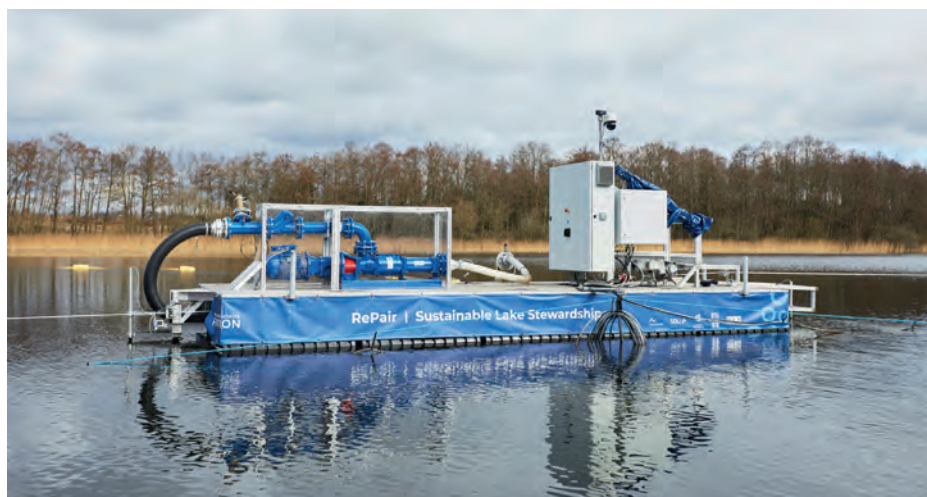
Søbotten er udviklet af Dansk Ingeniørservice (DIS) med støtte fra Poul Due Jensen Fonden. Den har et sugehoved, der ligger på bunden og skånsomt suger 40 kubikmeter sediment op i timen.
