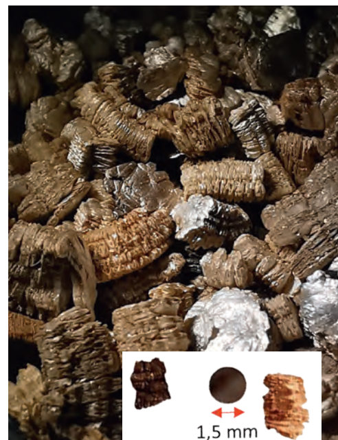
Figur 4. Vermiculit efter opvarmning, hvor planerne åbner sig, til venstre. (SEM-billede til venstre taget af Pia Bomholt Jensen, Interdisciplinary Nanoscience Center – iNANO, Aarhus Universitet).
