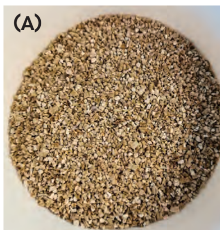
Figur 4. Vermiculit efter opvarmning, hvor planerne åbner sig, til venstre. (SEM-billede til venstre taget af Pia Bomholt Jensen, Interdisciplinary Nanoscience Center – iNANO, Aarhus Universitet).
