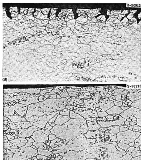
Figur 3. Øverst: Korrosion i brændselskredsløbet ved tab af materiale for Hastelloy N (INOR-8) efter 800 dage ved >500^{\circ}\text{C} i smeltet salt med bestråling på 1.5 \cdot 10^{21} neutrons/cm 2 . Nederst: Korrosion i kølekredsløbet, blandt andet på grund af tab af krom i korngrenser Hastelloy N (INOR-8) efter 800 dage ved >500^{\circ}\text{C} i smeltet salt uden bestråling [3].
