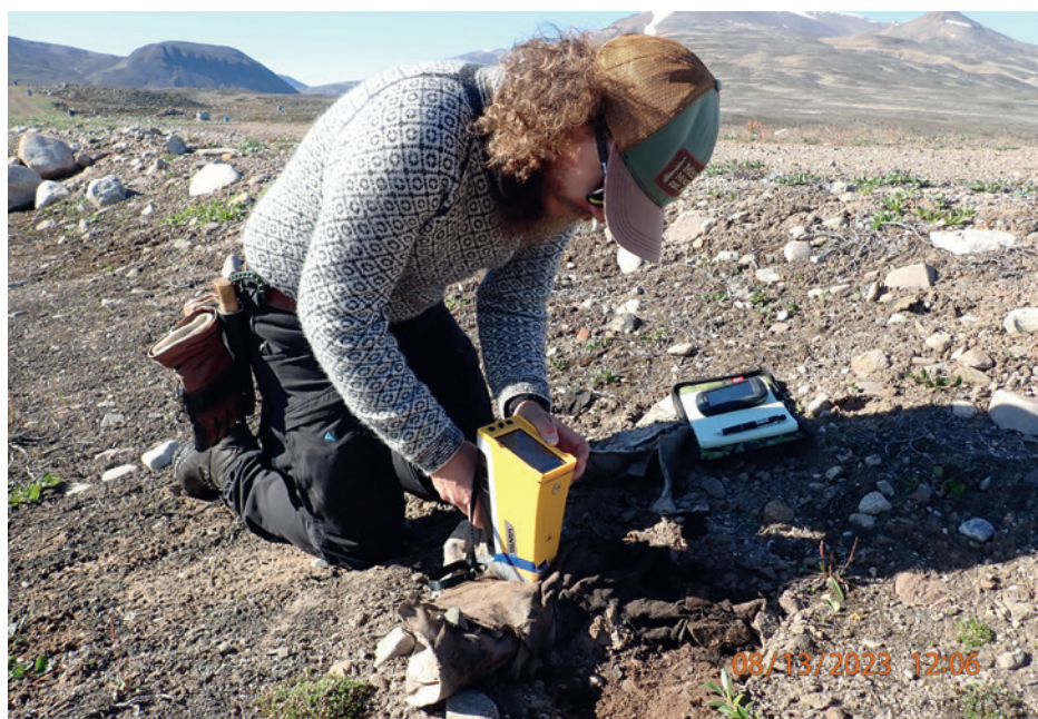
In situ måling af grundstofsammensætning af miljøprøver med bærbar XRF (pXRF).
