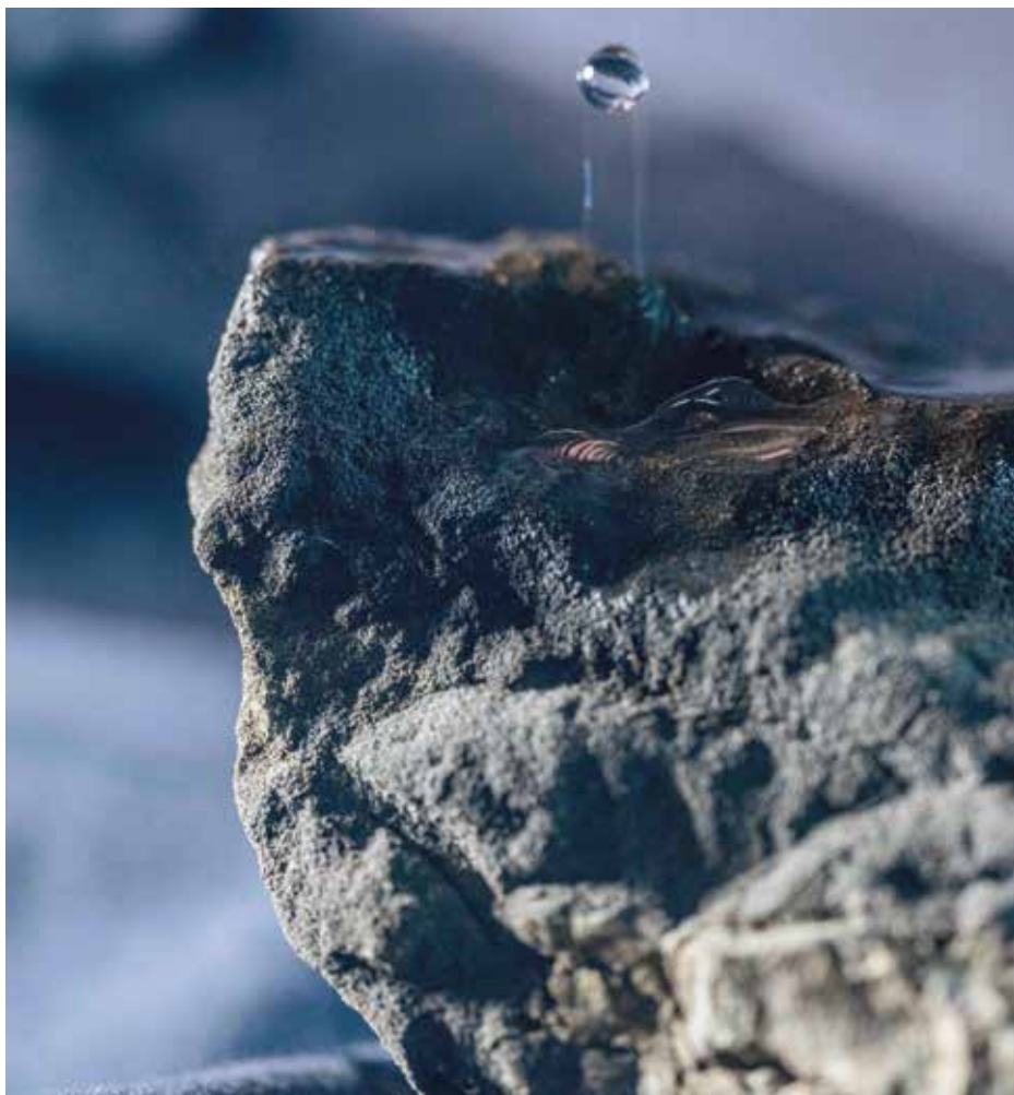
Figur 2. Et stykke vulkansk aske udsættes for vand mættet med CO 2 . Når det svagt sure vand reagerer med mineralerne i asken, frigives blandt andet calcium, der bindes sammen sidenhen med kulstoffet i nye karbonatminerale. På den måde kan CO 2 i princippet gå fra at være opløst i vand til at blive bundet som fast kalksten.
