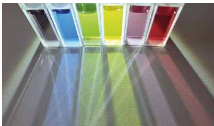
Figur 4. En række komplekser baseret på let tilgængelige metaller i opløsning. Kompleksernes farve bestemmes af sammenspiillet mellem metallet og liganderne, for eksempel er den gule opløsning [\text{Fe}(\text{pbmi})_2]^{2+} og den røde opløsning et mangan-carben kompleks.
